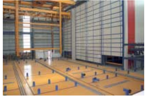
Fig. 13 The curing chambers with the rack operator. Self-evident, storing and output are done fully automatically. Abb. 13 Die Trockenkammern mit dem Regalbediengerät. Ein- und Auslagerung erfolgen selbstverständlich vollautomatisch.
