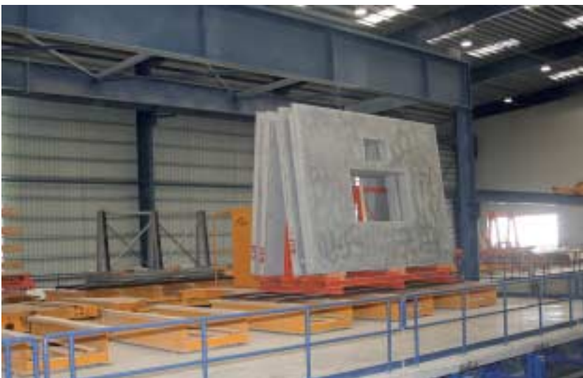
Fig. 14 Cured wall elements before transport into the storage area. Abb. 14 Ausgehärtete Wandelemente vor dem Transport in das Lager.
