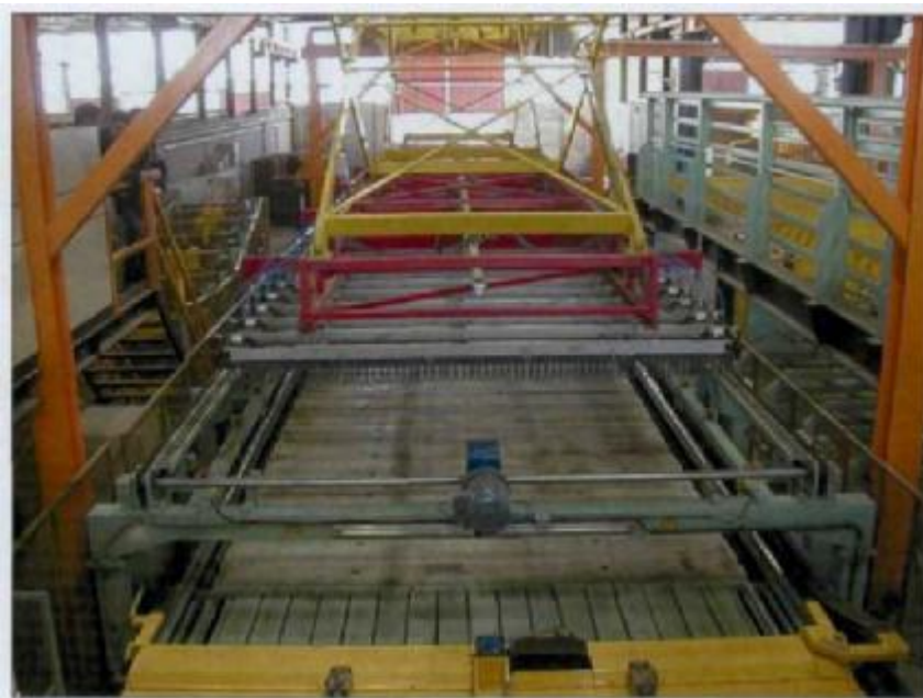
Кран-балка для арматурной сетки, укладывающий проволочную сетку
