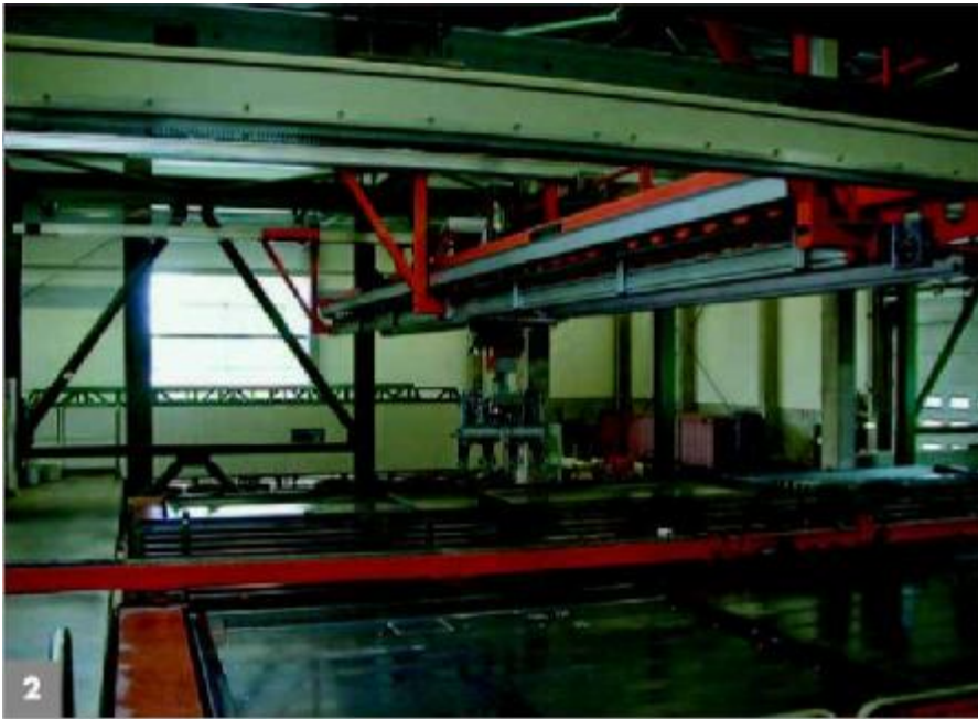
Опалубочный робот на 2-ух станциях
