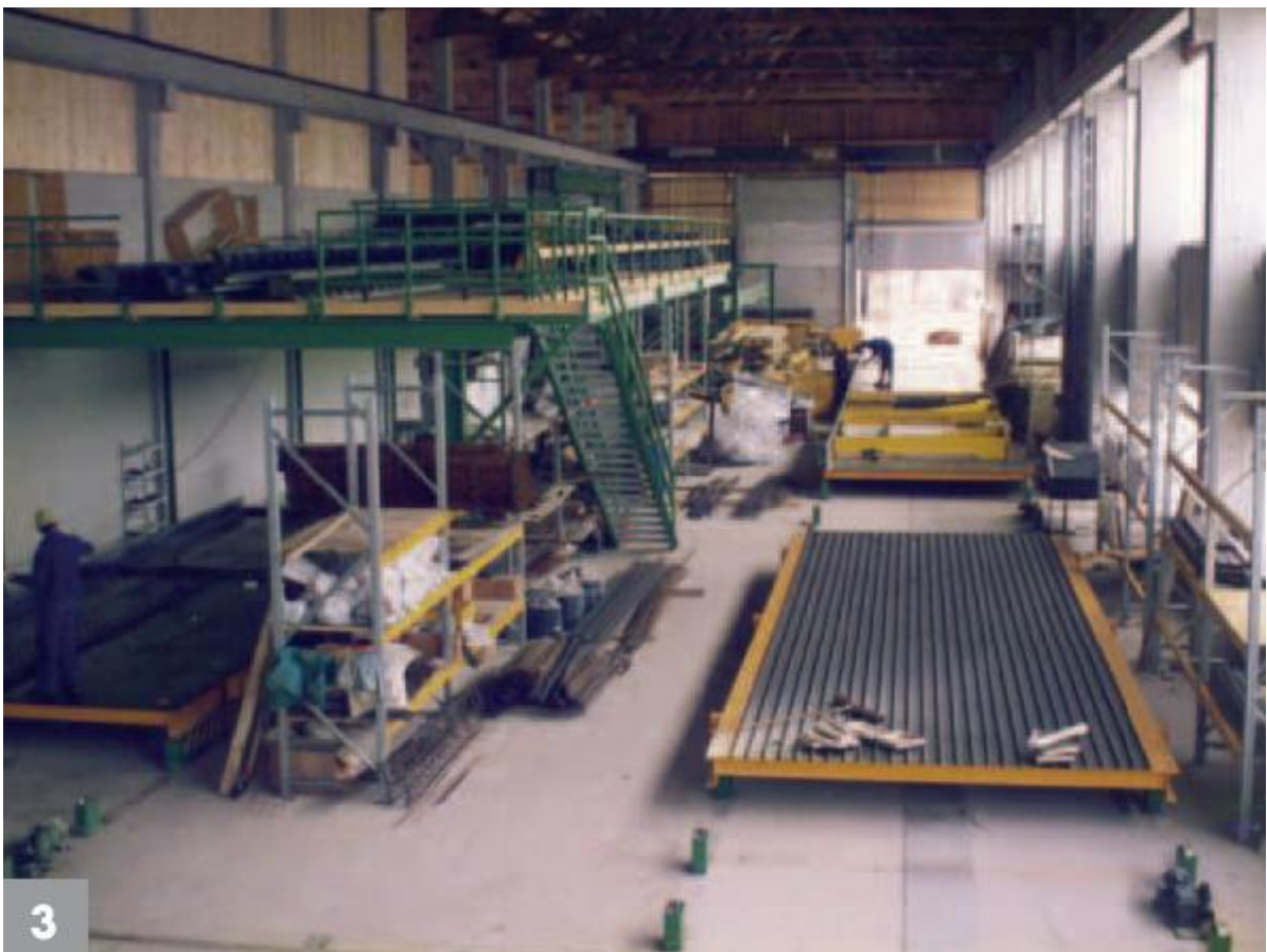
Производственная установка для изготовления сплошных стен в Таиланде, площадь завода 9600м 2 , производство 1,300,000 м 2 /год.
