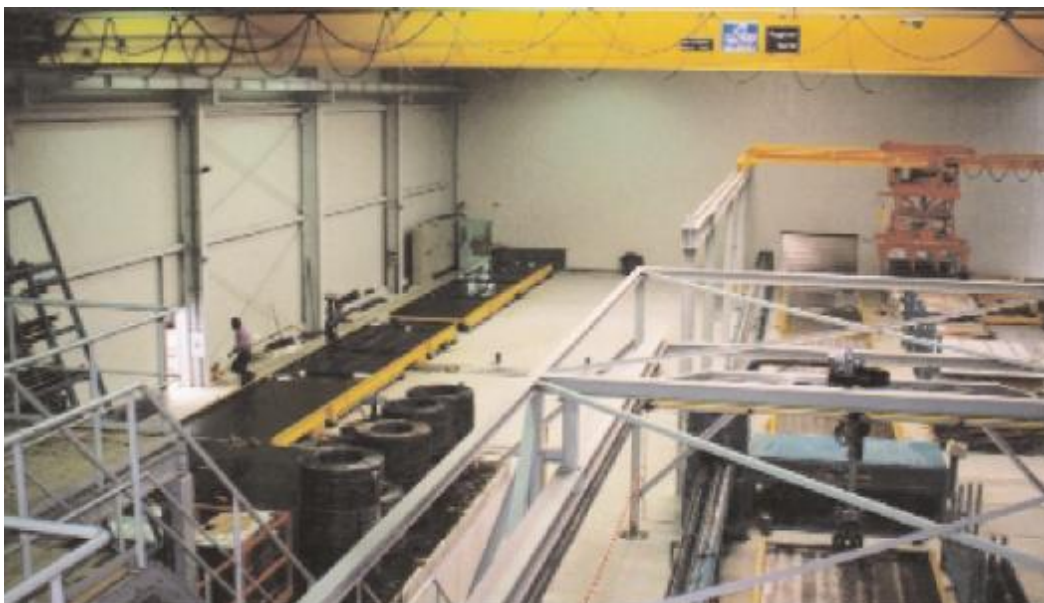
Производственный участок с зоной расформовки плит и формующим роботом-манипулятором.
