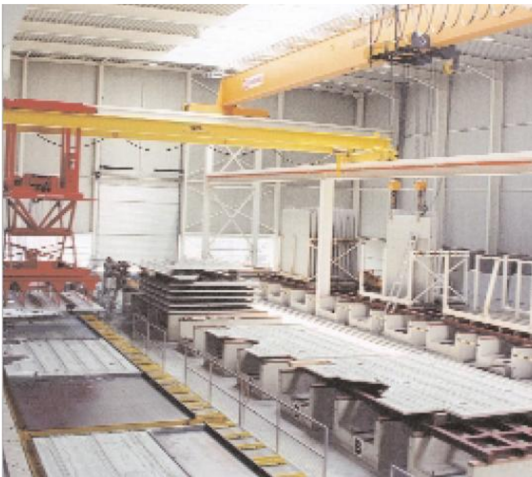
Зона расформовки: участок по производству элементов кровли и двойных стен
