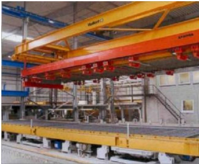
Поворотный механизм во время производства полой стены.
