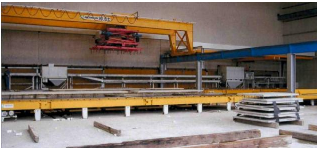
Зона удаления опалубки с подъемным устройством для элементов перекрытий.
