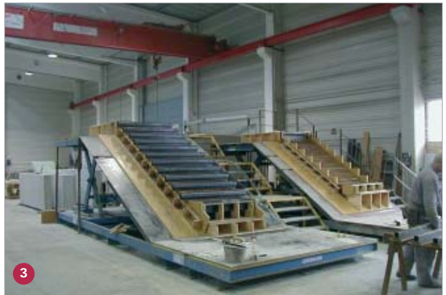
Schalrampe, gelagert auf einem Luftkissensystem
