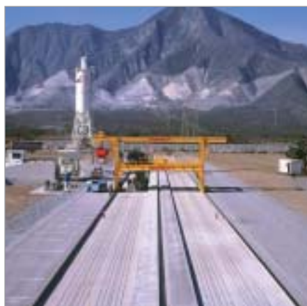
Mehrbettmaschine für die Produktion von 1,20 und 2,40 m breiten Elementen in Monterrey, Constructora Moyeda
