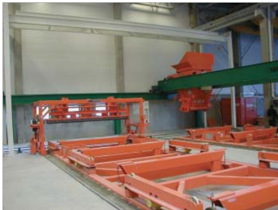
Verdichtungsstationen, Betonverteiler und Tandemglätter
