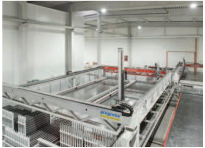
Die Station für den Schalungsroboter
