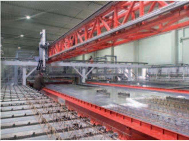
Bild von der zweisträngigen Führung der Paletten im Bereich des Bewehrungsroboters
