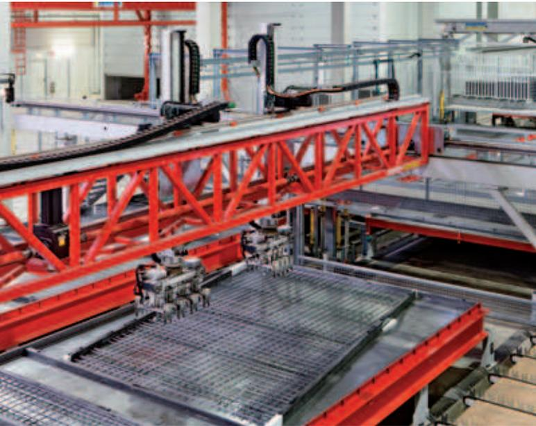
Bewehrungsanlage. Der Eingriff eines Mitarbeiters ist lediglich zum Wechseln der Bewehrungscoils, zum Auffüllen der Gitterträger und der Abstandhalter notwendig. Diese Tätigkeiten werden von einem Mitarbeiter der anschließenden Nacharbeitsstation erledigt.
