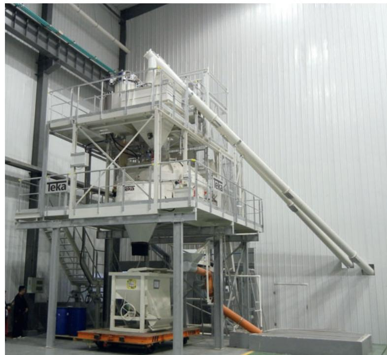
*Instalación mezcladora de hormigón de Teka*
