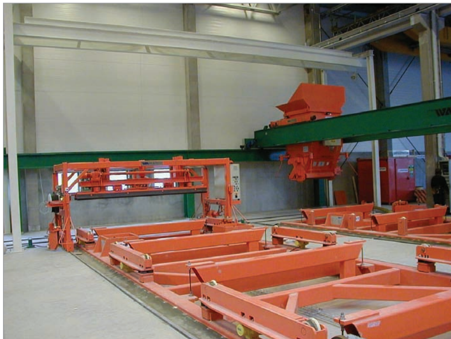
Verdichtungsstationen, Betonverteiler und Tandemglätter
