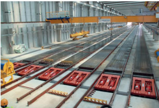
Fertigungsanlage für Spannbetonfertigdecken
