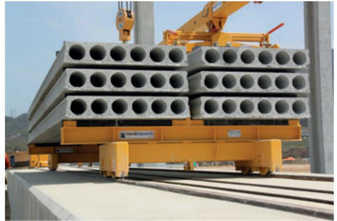
Fördersystem für Spannbetonfertigdecken
