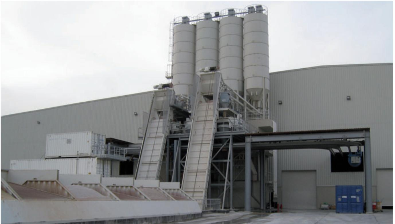
Mischanlage und Betontransportsystem
