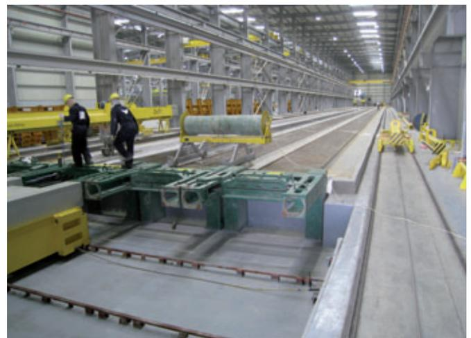
Produktionsanlage für Spannbetonfertigdecken
