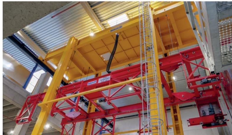
Auf der Zwischenebene folgt in einer weiteren Ausbaustufe das Oberflächenfinish, direkt angedient über das VArío Store Regalbediengerät.
