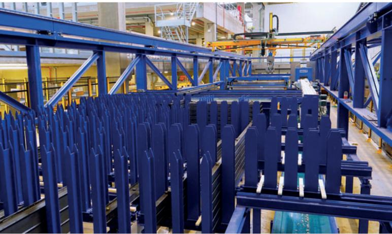
*Der Smart Set Schalungsroboter übernimmt auch die Zwischenlagerung der Abstellprofile nach dem Reinigungsvorgang in die Lagergestelle.*
