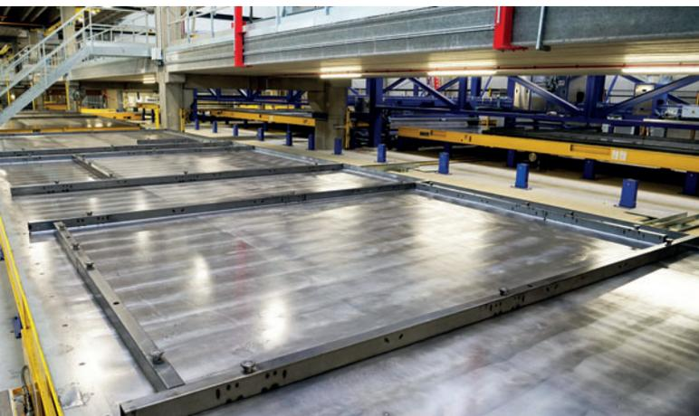
*Einzelne Umlaufpaletten werden aus der Linienfertigung in separate Pufferplätze herausgeschleust, abgetrennt durch spezielle vertikal verfahrbare Absperrzäune.*
