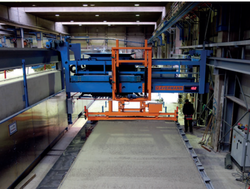
Fig. 6: Distribuidor de hormigón de disposición en puente con regla enrasadora
