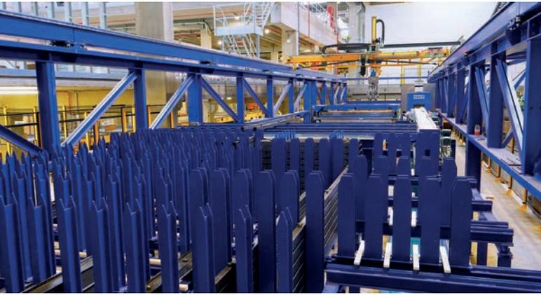
*El robot de encofrado SMART SET también se encarga del almacenamiento intermedio de los perfiles de encofrado después del proceso de limpieza en los estantes de almacenamiento*
