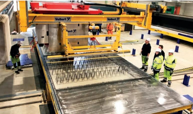
*Un distribuidor de hormigón SMART CAST guiado por un puente, totalmente automático (fuente: Kerkstoel 2000+) asegura tiempos de ciclo de hormigón óptimos y una dosificación exacta del hormigón.*
