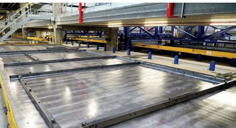
*Las bandejas individuales de circulación se transfieren de la producción en línea a ilas de trabajo intermedias separadas por barreras especiales de movimiento vertical*
