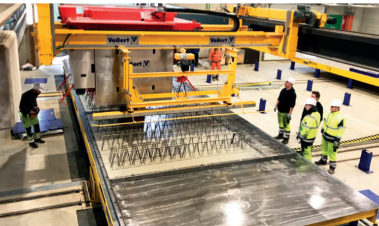
Рис. 7. Полностью автоматический бетонораздатчик Smart Cast с направляющим мостом обеспечивает оптимальное цикловое время и точное дозирование бетонной смеси (источник: Kerkstoel 2000+)
