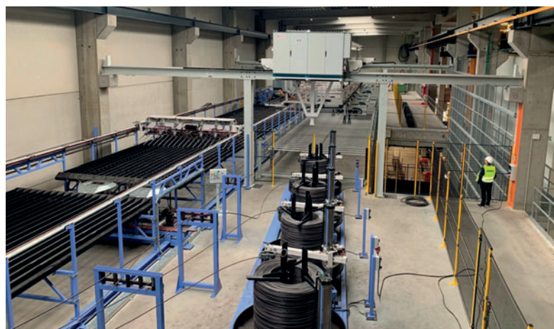
Рис. 5. Подготовка арматуры происходит в полностью автоматическом режиме на более высоком промежуточном уровне
