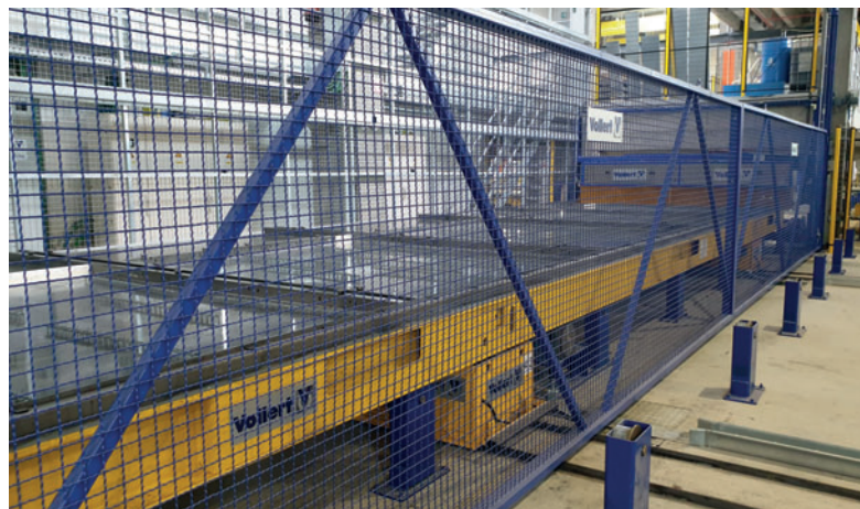
Рис. 6. Некоторые оборотные поддоны выводятся из производственной линии в отдельные накопительные зоны, разделенные специальными, вертикально перемещаемыми барьерными ограждениями
