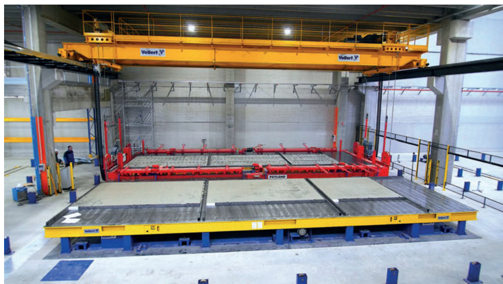
Рис. 9. На заводе Kerkstoel 2000+ были реализованы важные технические инновации для увеличения продолжительности цикла, а также в области эргономики и безопасности труда в производстве двойных и многослойных стеновых панелей
