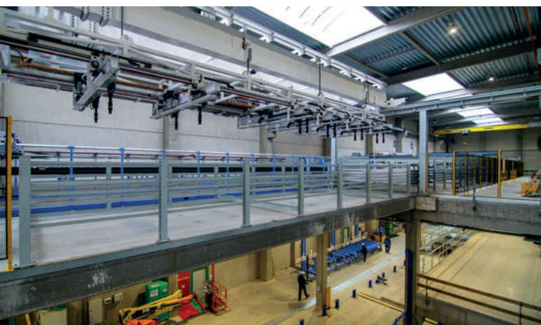
Рис. 5. Подготовка арматуры происходит в полностью автоматическом режиме на более высоком промежуточном уровне
