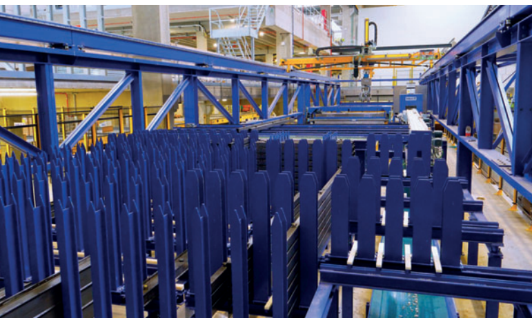
Рис. 4. Опалубочный робот Smart Set также передает очищенные опалубочные профили на место складирования
