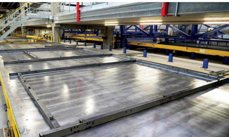
Рис. 6. Некоторые оборотные поддоны выводятся из производственной линии в отдельные накопительные зоны, разделенные специальными, вертикально перемещаемыми барьерными ограждениями
