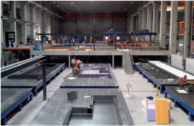
Para la colocación manual de la armadura y la colocación del aislamiento, las paletas pasan a continuación por tres líneas de fabricación independientes y paralelas entre sí
