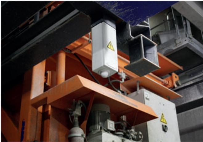
Antena IWLAN en el distribuidor de hormigón
