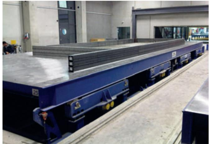
La compactación del hormigón después del proceso de hormigonado se realiza mediante una estación de compactación combinada de agitación/vibración
