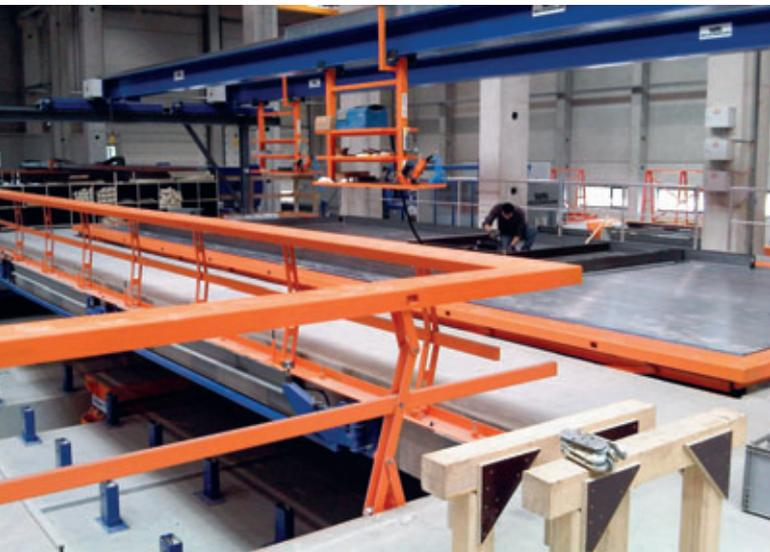
*Para no obstaculizar el ciclo de las paletas, el encofrado manual posterior tiene lugar en un segundo nivel de trabajo por encima del sistema de circulación*
