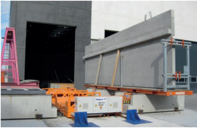
La solución de carga suministrada por Vollert permite recoger los bastidores de apoyo mediante un carro de salida para transportarlos a continuación a la zona exterior
