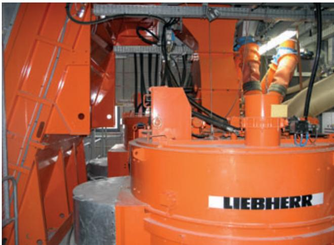
Dos mezcladoras de eje vertical de Liebherr permiten alcanzar una elevada calidad del hormigón en un corto tiempo de mezcla
