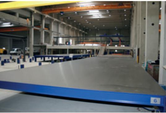
En FBW se utilizan un total de 40 paletas de encofrado de 14,00 x 4,60 m
