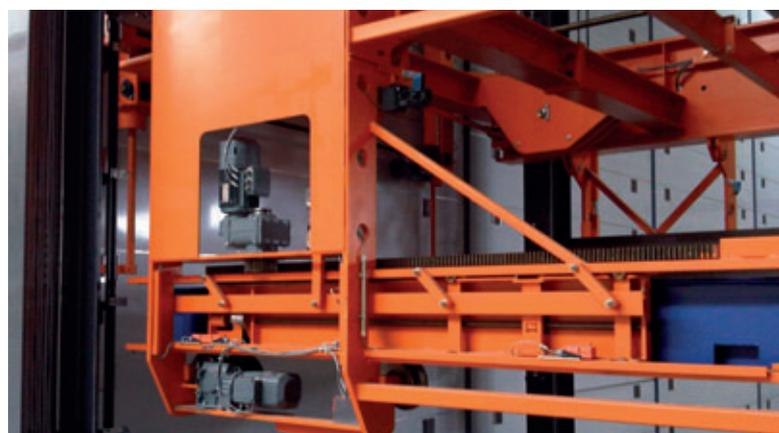
Las puertas de las estanterías son accionadas a través de un abridor de puertas segmentadas antes de que las paletas entren o salgan mediante ruedas de fricción y una corredera de cremallera al compartimento de paletas deseado
