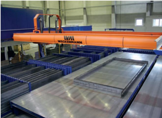
*El robot de encofrado Twin-Z hace posible tiempos de ciclo extremadamente rápidos para el posicionamiento de los encofrados sobre las paletas de acero*
