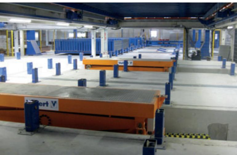
*Mesas elevadores hidráulicas de tijera de Vollert levantan las paletas de encofrado en un total de tres posiciones hasta las estaciones individuales de procesamiento posterior a una altura de elevación de 2,80 m*
