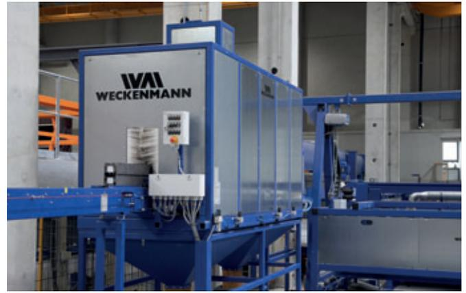
Estos se limpian y lubrican en la estación de limpieza de encofrados y luego se devuelven al depósito del robot de encofrado en función de su identificación.
