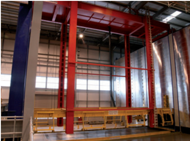
Fig. 13: Aparato de servicio de estantes del circuito HSC
