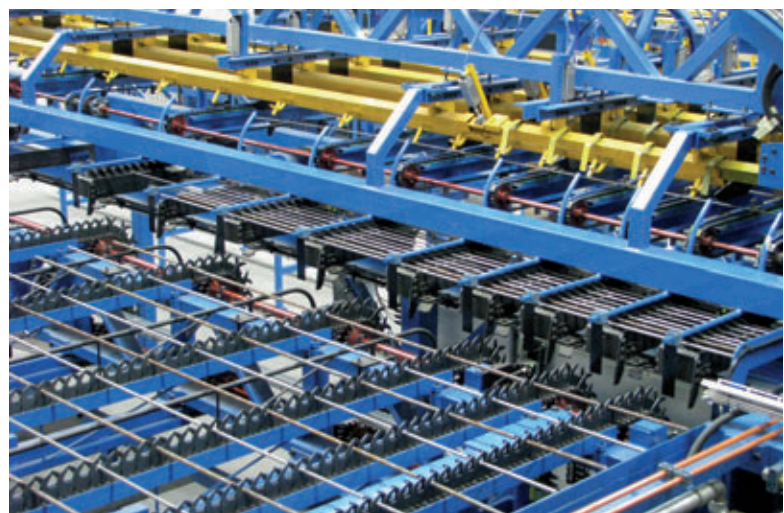
Fig. 27: Alimentación de barras longitudinales
