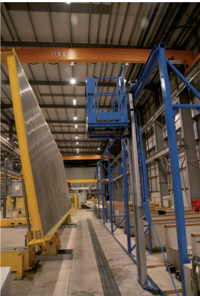
Fig. 14: Mesa de volteo con plataforma para el operario
