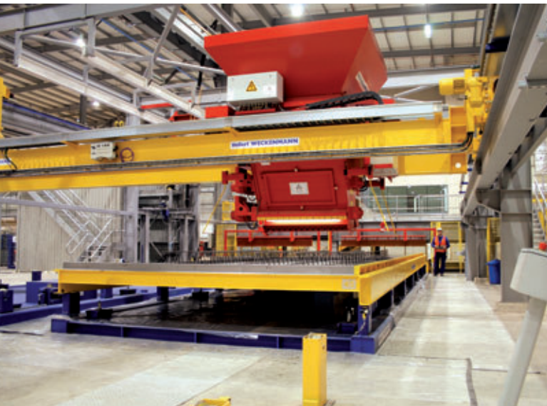
Fig. 9: Distribuidor de hormigón y estación de compactación
