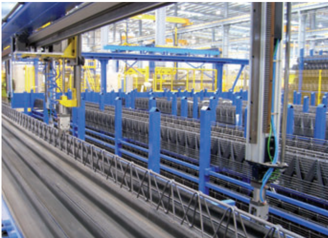
Fig. 33: Almacén activo de vigas de celosía
