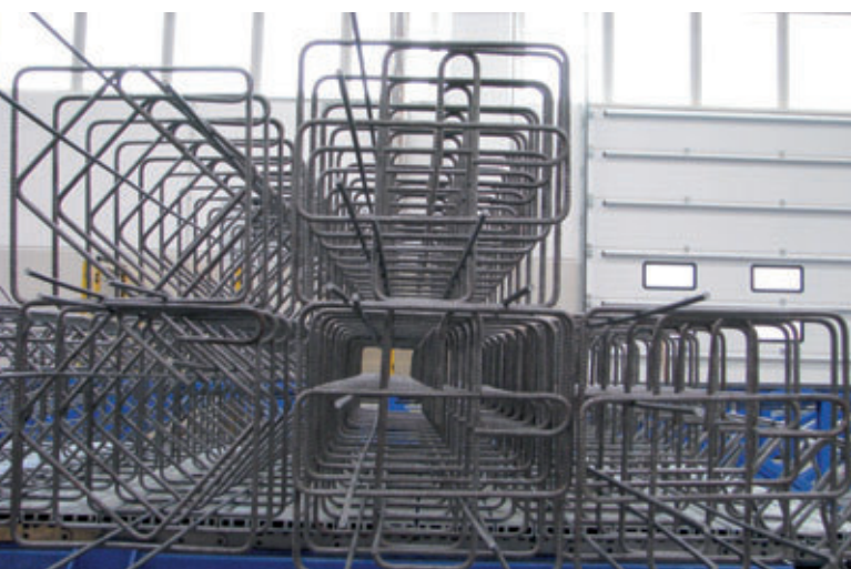
Fig. 31: Jaulas de armadura fabricadas en la "Autobend" de AWM
