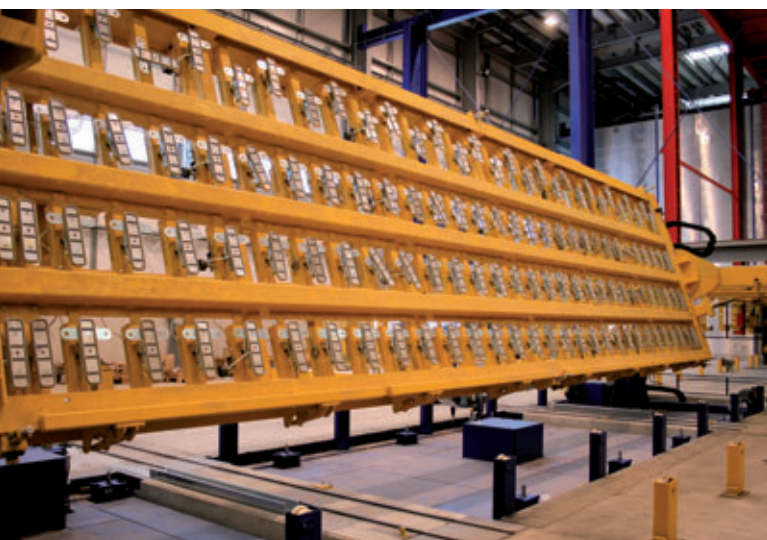
Fig. 11: Marco de volteo de succión
