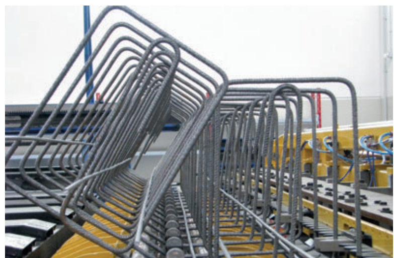
Fig. 32: Cierre de una jaula de armado con la "Autobend" de AWM
