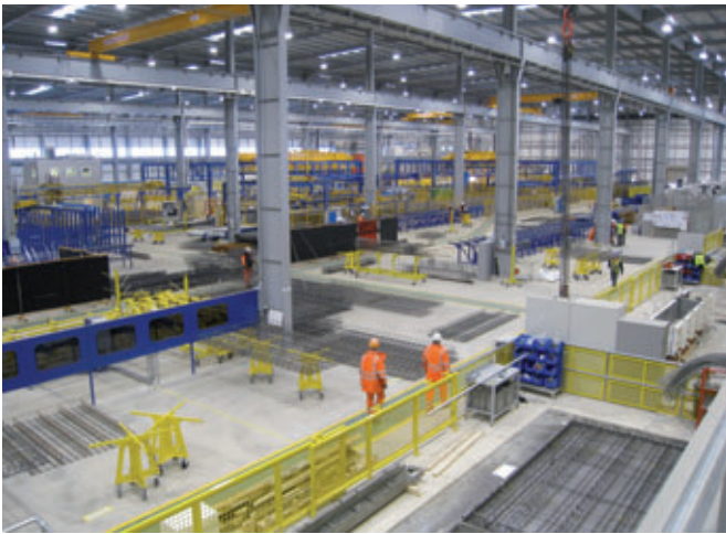
Fig. 35: Zona de montaje de jaulas de armadura
