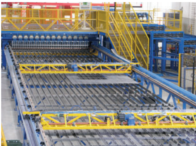
Fig. 29: Vía del ascensor y pinzas de arrastre
