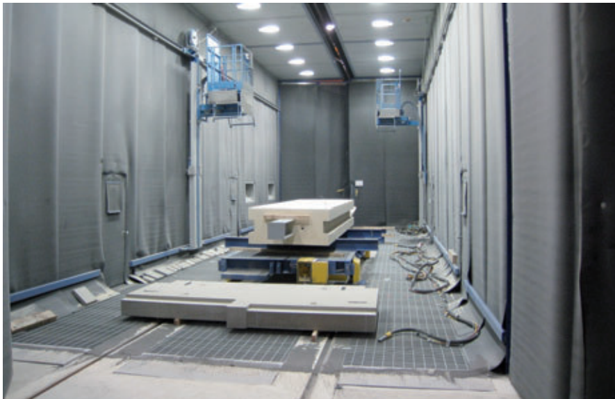
Fig. 38: Cabina de arenado
