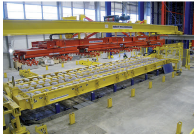
Fig. 12: Elevación y marco de volteo de succión (durante el montaje)
