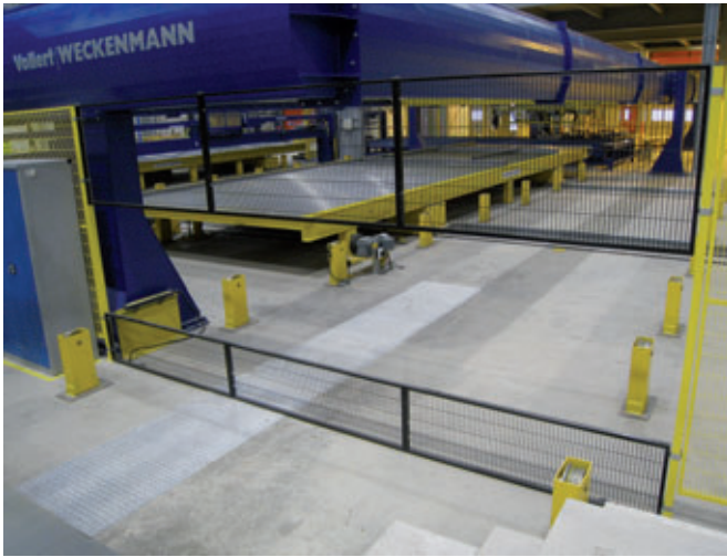
Fig. 40: Valla de protección y barrera de luz
