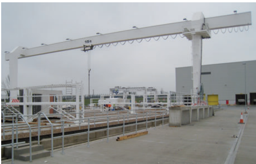
Fig. 39: Grúa del almacén para la producción estacionaria de piezas especiales
