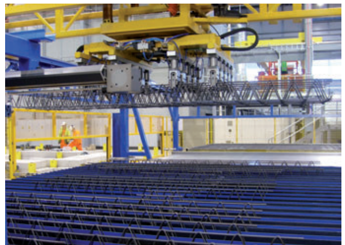
Fig. 34: Robot de posicionado de vigas de celosía
