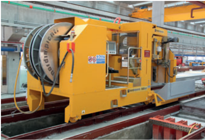
Sierra angular universal 500 AM de Nordimpianti
