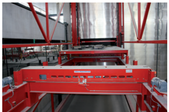
Das Regalbediengerät bedient die 33 Plätze des beheizten Härteregals
