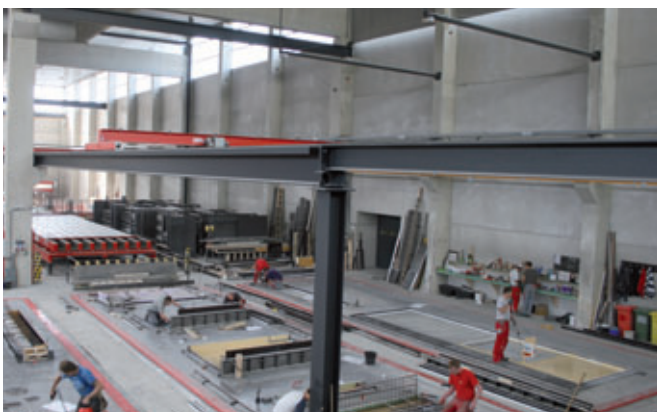
Vom Bedienraum hat man alle Arbeitsstationen gut im Blick, mittig über den Arbeitsstationen M01 und M02 wurden die Projektionslaser von Unitechnik installiert.
