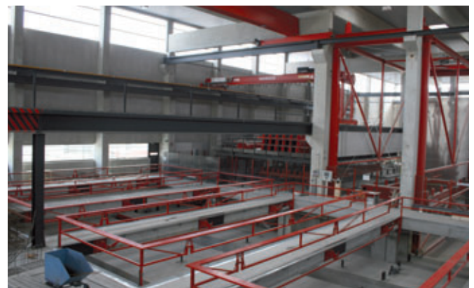
Vom Bedienraum hat man alle Arbeitsstationen gut im Blick, mittig über den Arbeitsstationen M01 und M02 wurden die Projektionslaser von Unitechnik installiert.
