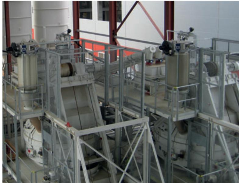
Plataformas de mezcladoras y básculas con alimentador con descarga de fondo e instalación de silos al fondo
