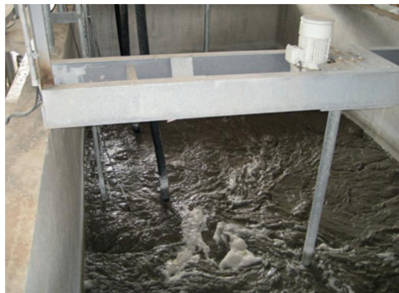
Agitadores en el tanque con agitador del sistema de reciclaje de Bibko
