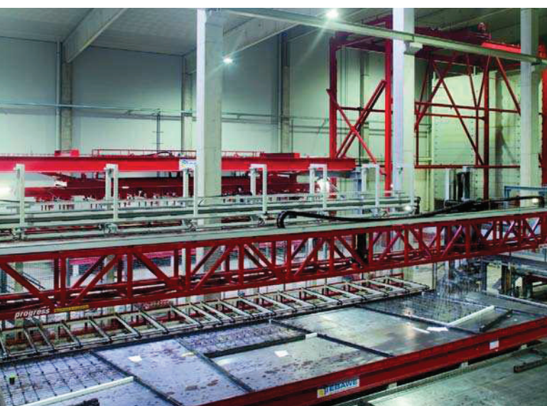
Роботизированная укладка арматуры
