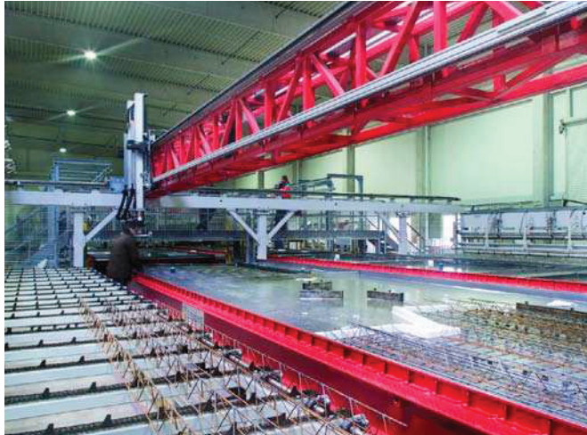
Изображение двух линий подачи поддонов на участке робота-укладчика арматуры
