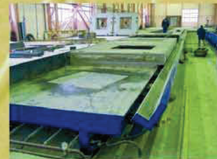
Производственные линии для выпуска внешних панелей толщиной 400 mm.
