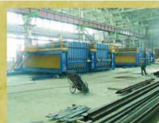
Кассета Вертикальная на 10 + 10 отсеков заливки
