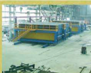
Кассета Вертикальная на 10 + 10 отсеков заливки
