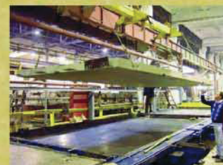
Плиты перекрытия толщиной 160 mm. в три слоя.
