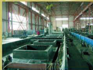
Производственные линии для выпуска внешних панелей толщиной 400 mm.
