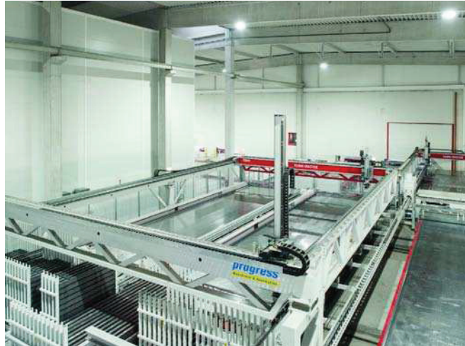
Роботизированная станция опалубки
