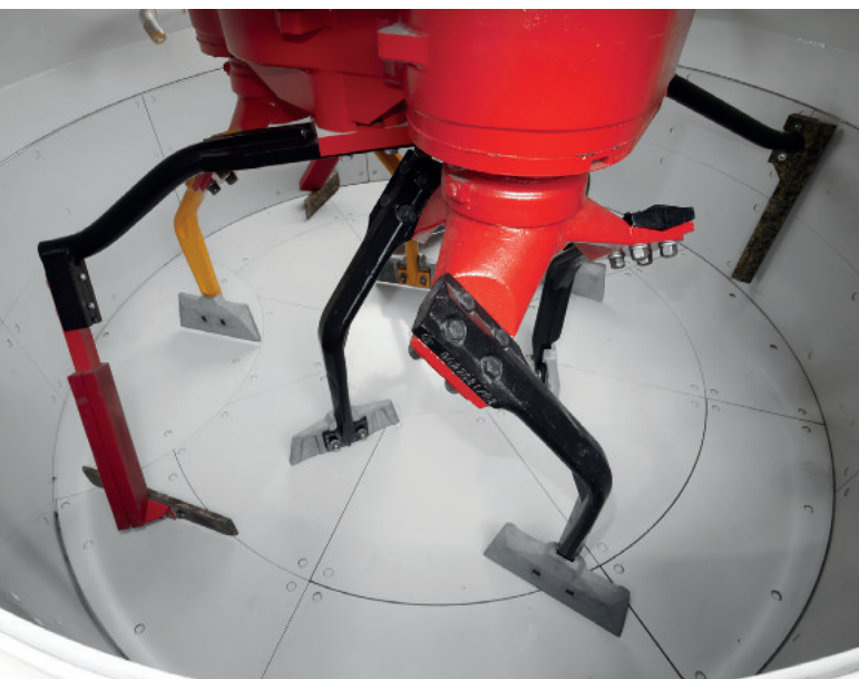
Планетарный смеситель TeKa TPZ 3750, работающий по противоточному принципу
