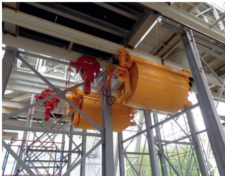
Общая длина кубельных транспортеров составляет 1600 м
