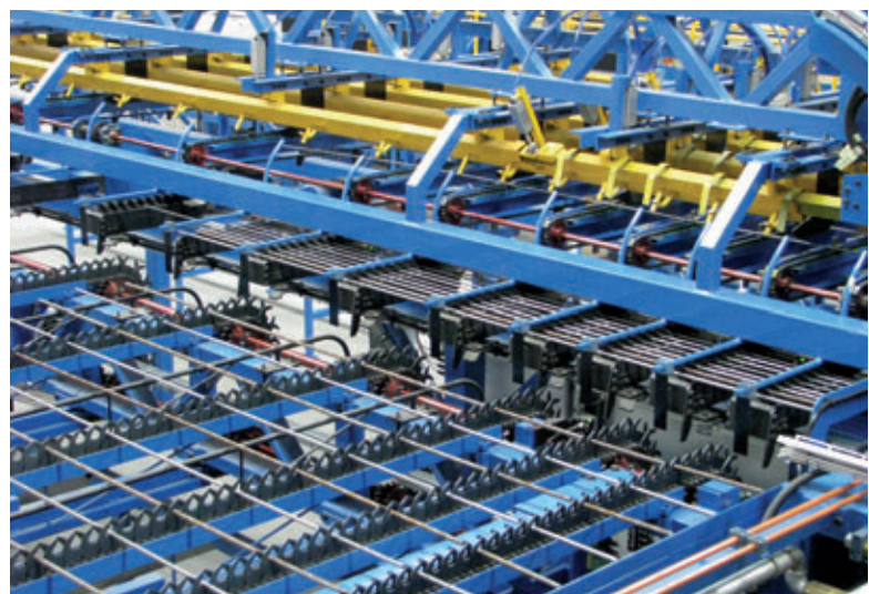
Fig. 27: Longitudinal Bar Feeding
