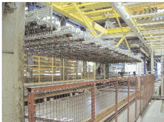
**Automatischer Mattenkran beim Einlegen der Bewehrungsmatten**
