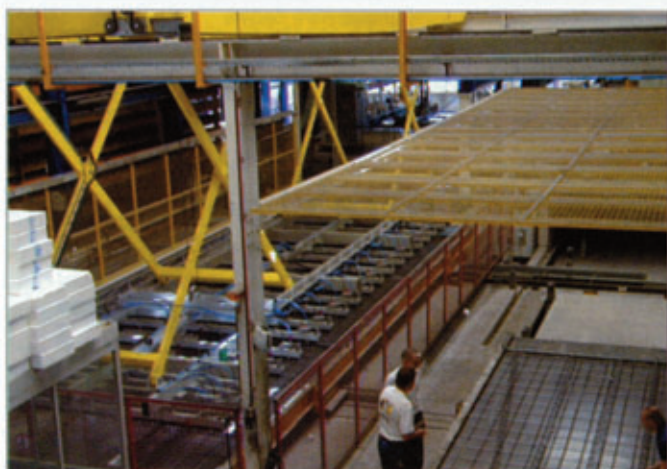
La grúa automática para mallas colocando mallas de armadura
