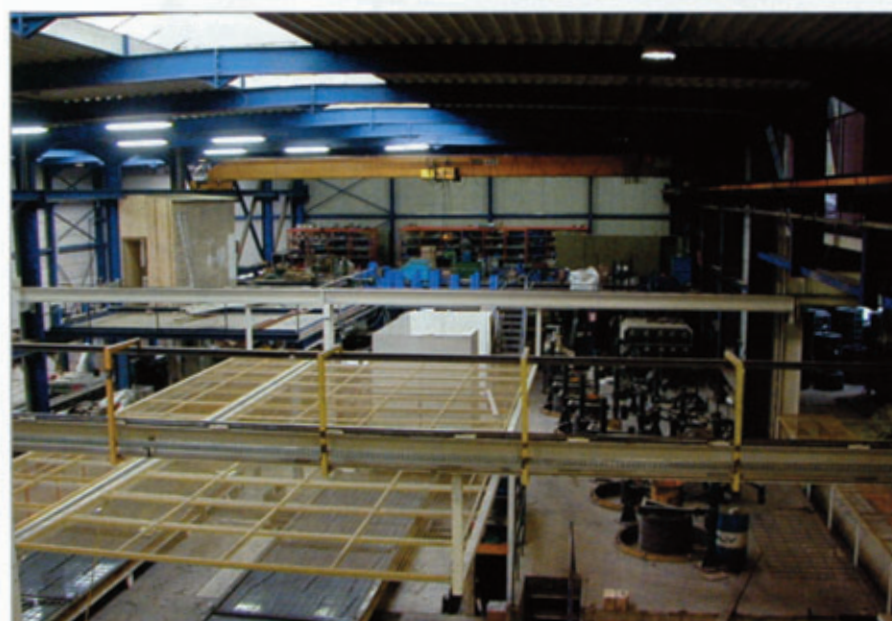
El área de armado antes de la renovación, en segundo plano la planta enderezadora para las barras de acero
