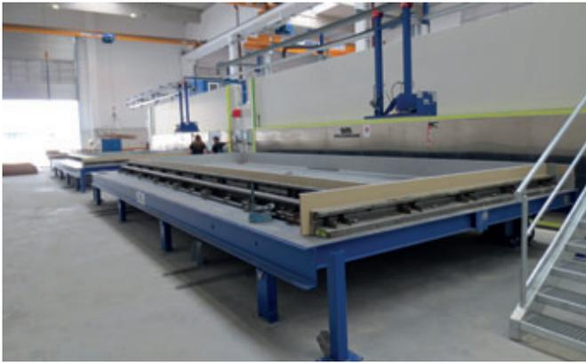
Estaciones de encofrado con proyección láser
