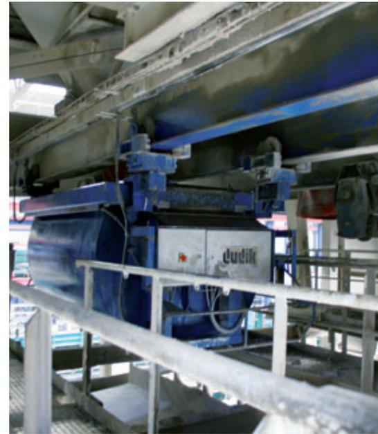
La distribución del hormigón a las estaciones de colado tiene lugar mediante un sistema de cubetas
