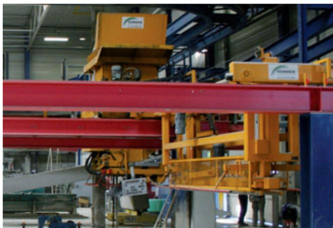
La estación de hormigonado para la producción de placas nervadas
