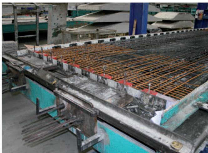
Molde para placas nervadas con armadura pretensada y sin pretensar
