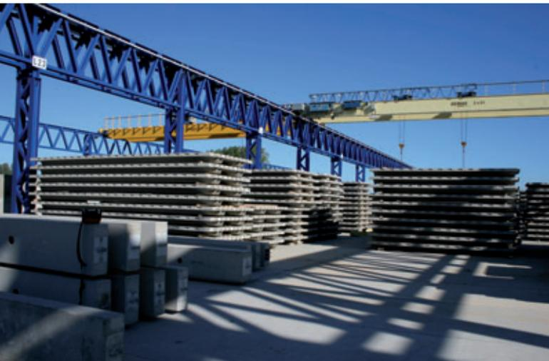
Las placas nervadas, ya sean pretensadas o sin pretensar, se fabrican en función del proyecto y se almacenan temporalmente.
