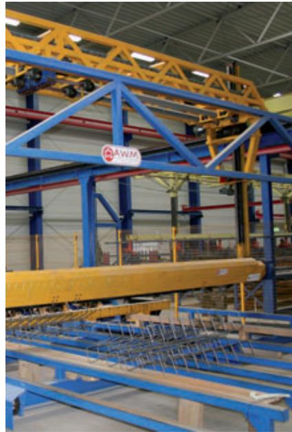
Para la prefabricación precisa de la armadura, en la parte delantera de la nave se encuentra una máquina dobladora de mallazos automática
