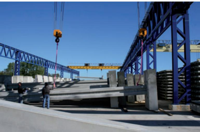
Pilares prefabricados de hormigón durante la carga
