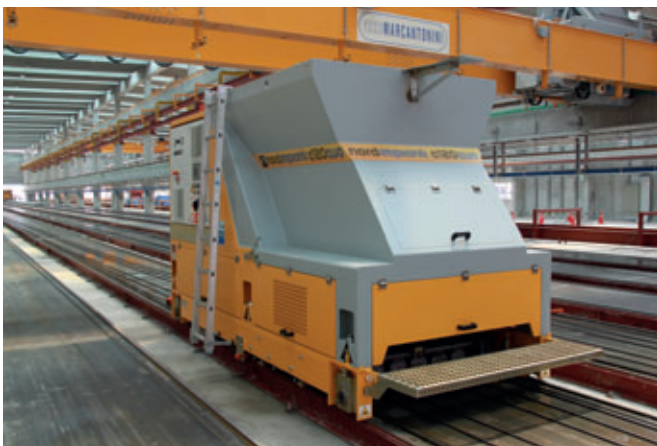
New Nordimpianti EVO Extruder casting Machine
