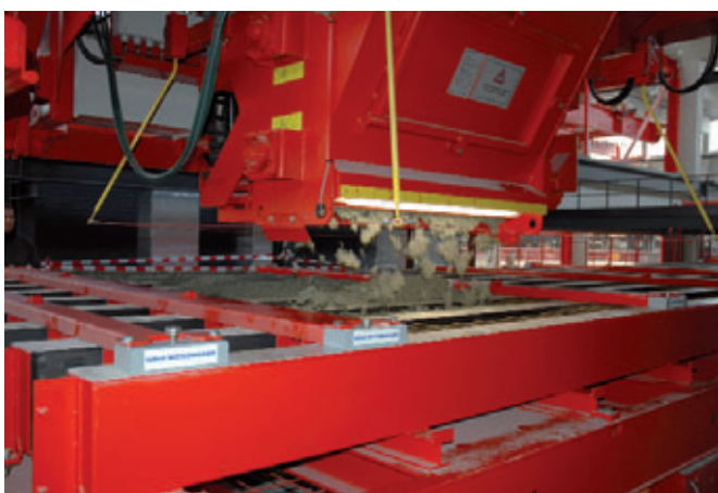
El distribuidor de hormigón permite llenar el encofrado con precisión
