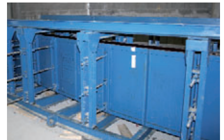
Encofrado del proveedor francés CTVS
