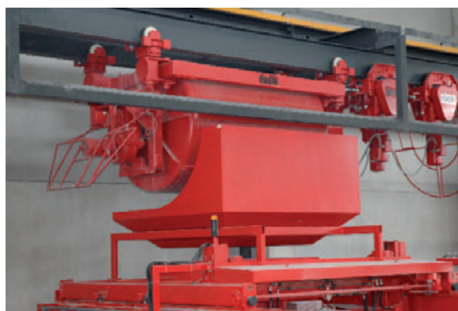
El circuito de cubetas de Dudik dirige el hormigón al distribuidor de hormigón
