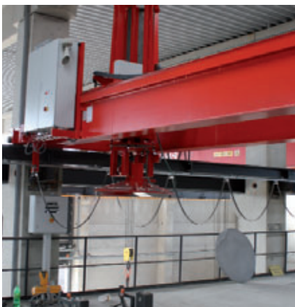
Alisadora de aspas sobre la cámara de curado
