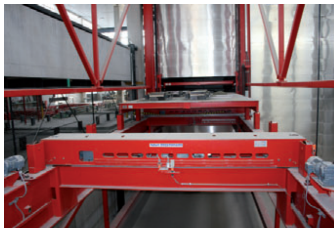
El aparato de servicio de estantes atiende a 33 plazas del estante de curado calefactado
