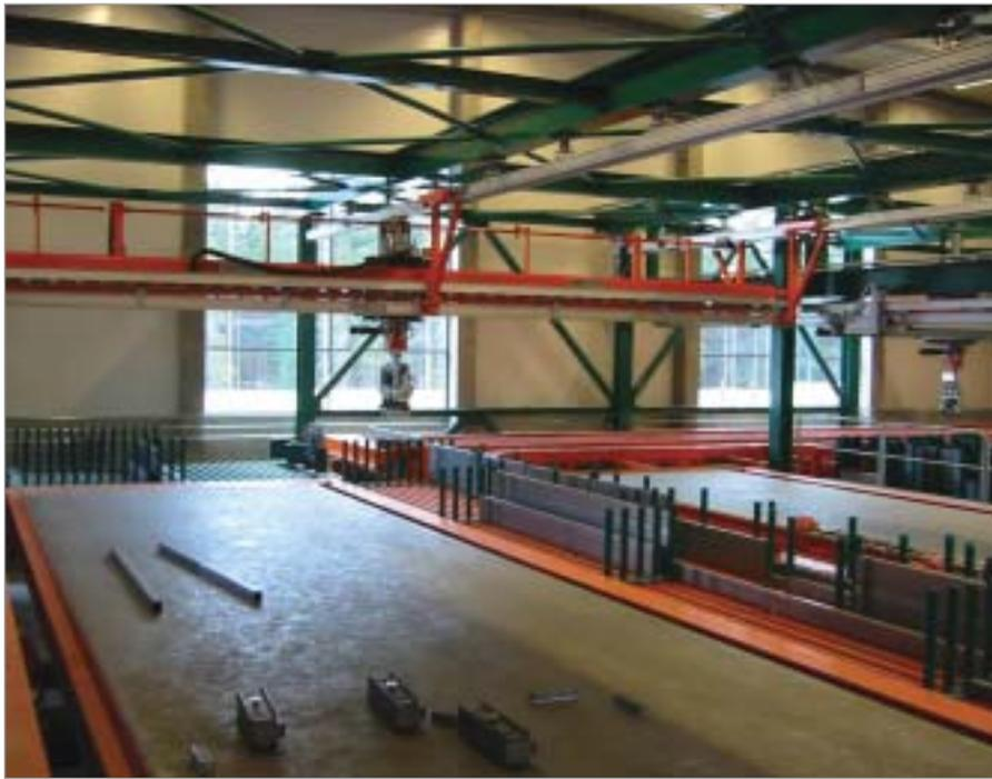
**El robot de encofrado y el robot del almacén durante la puesta en marcha**
