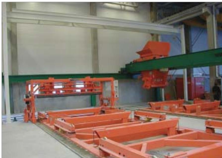
**Las estaciones de compactado, el distribuidor de hormigón y el dispositivo alisador**
