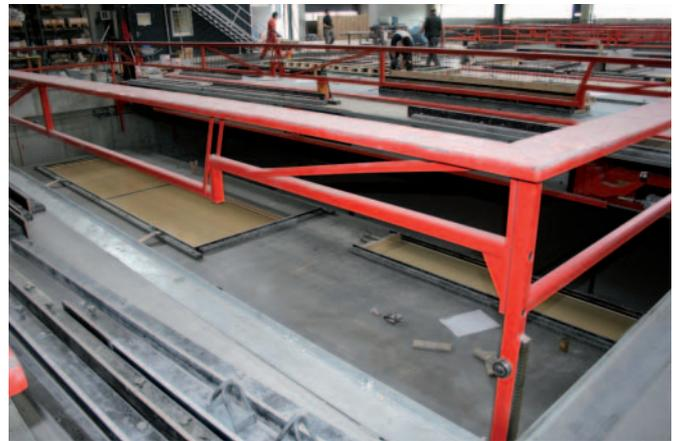
многослойных бетонных деталей. Проецируемую информацию можно разделить на несколько отдельных рисунков, которые рабочий легко может выбрать при помощи пульта дистанционного управления. Конфигурация отдельных рисунков и определение высоты проекции задается на главном компьютере UniCam.
