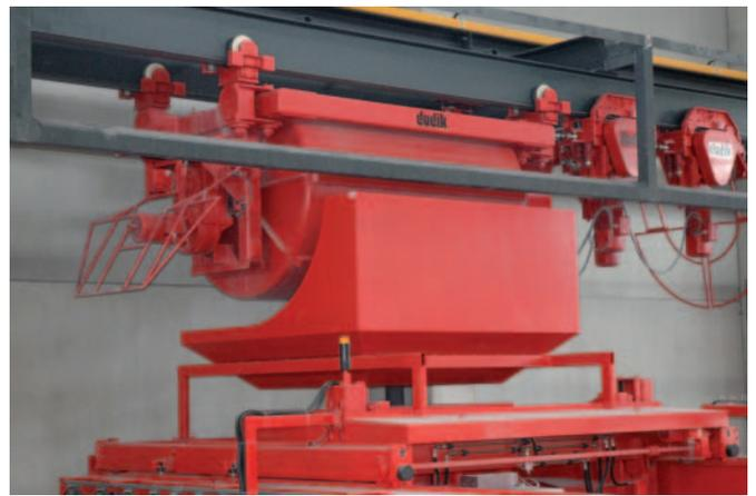
Кюбельный раздатчик Dudik подает бетон в распределитель бетонной смеси
