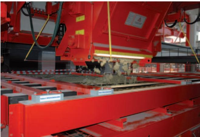
Распределитель бетонной смеси обеспечивает точное заполнение опалубки
