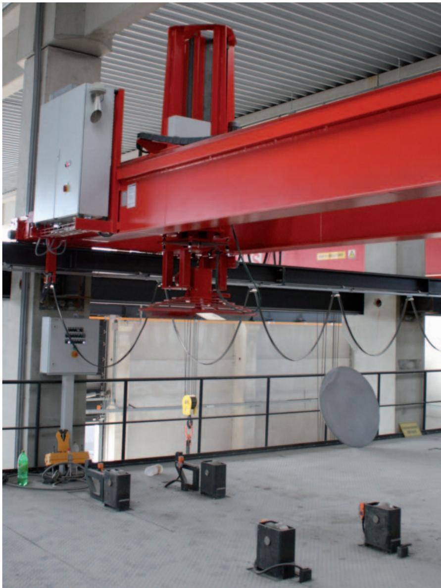
После разгрузки из камеры твердения сборные железобетонные элементы изымаются при помощи крана
