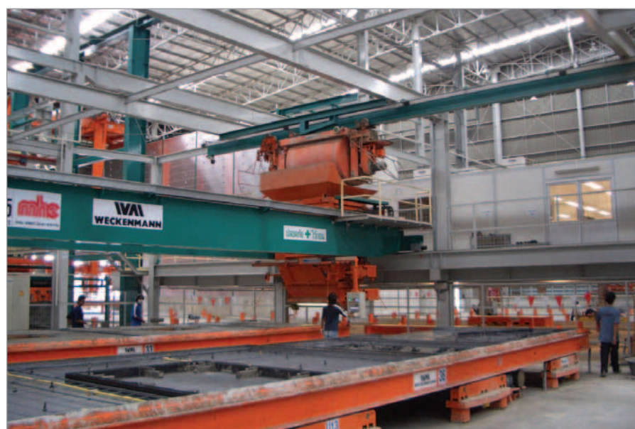
Las estaciones de hormigonado
