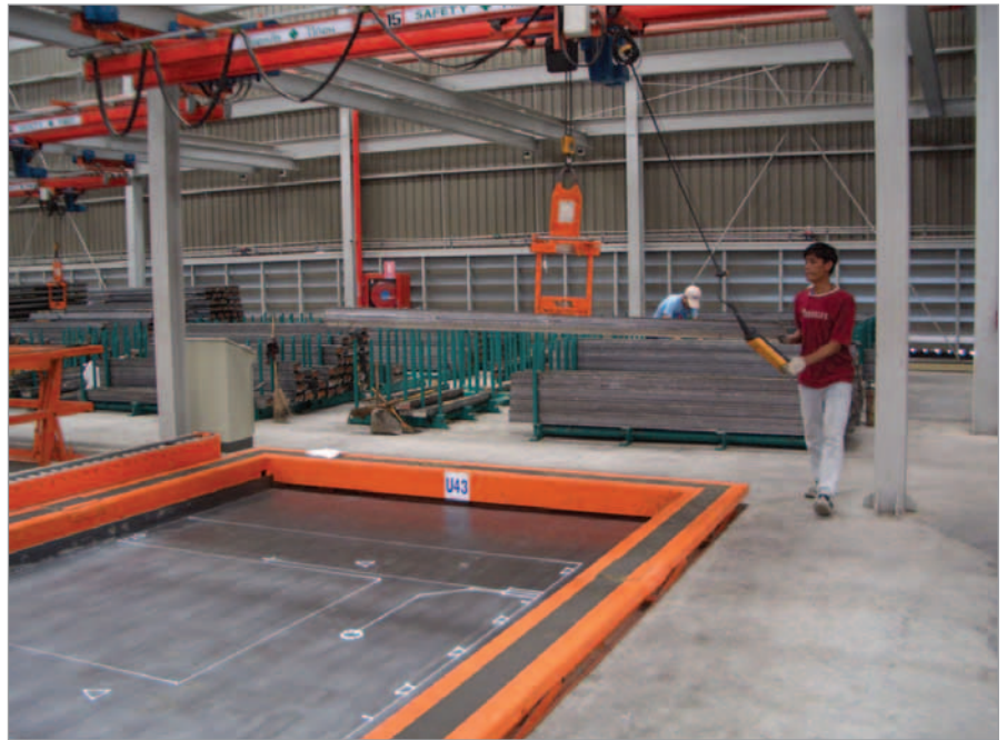
Zona de encofrado (colocación de los moldes)
