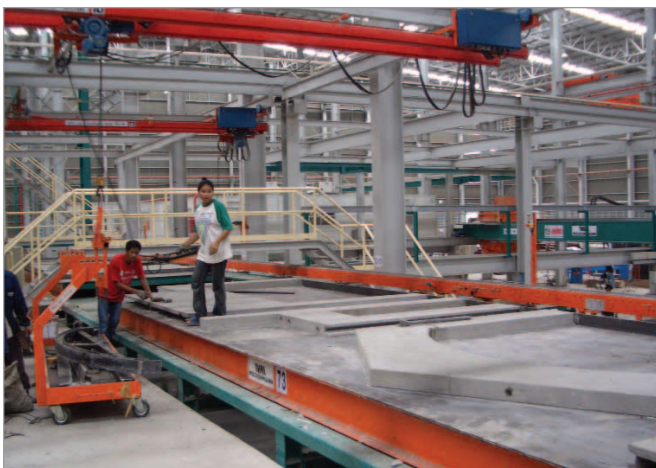
Zona de desencofrado
