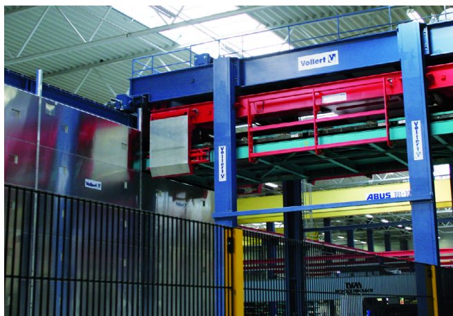
Стеллажный кран-штабелер и камера ТВО от компании Vollert
