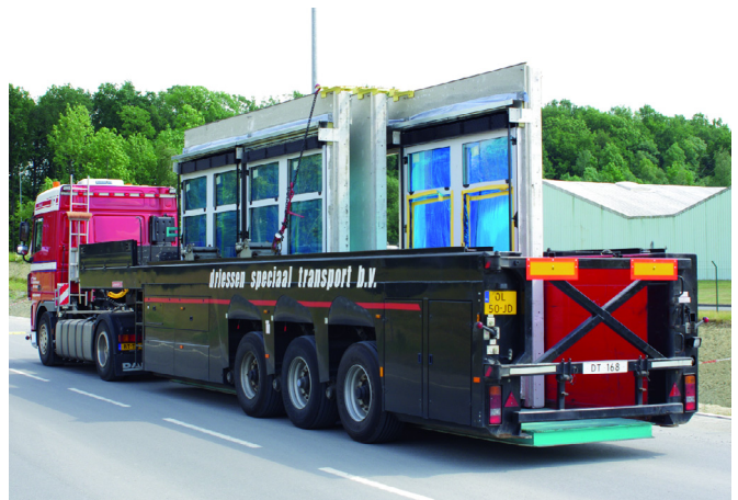
Перевозка панелей на стройплощадку
