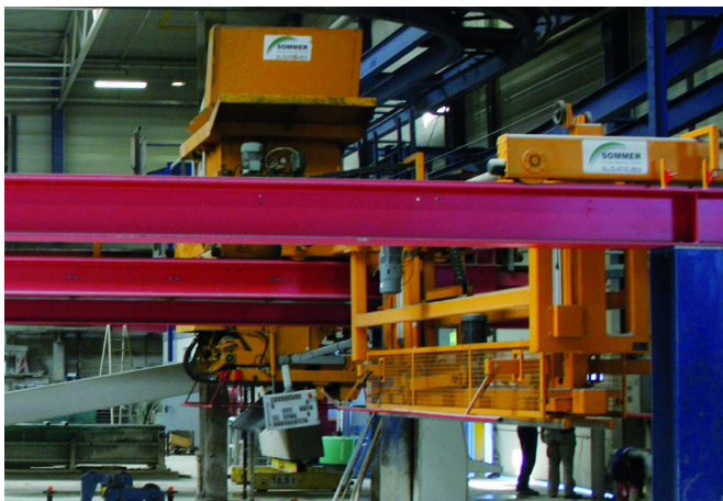
Линия формования от компании Sommer для производства ребристых перекрытий также снабжается бетоном по кубельной системе от Dudik
