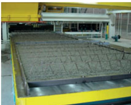
*Después de un desplazamiento de casi de 20 m, la cuba aérea de Dudik entrega el hormigón de la instalación de mezcla de la nave contigua al distribuidor de hormigón automático, que llena con hormigón las bandejas preparadas. La compactación subsiguiente proporciona una calidad superficial perfecta de los elementos prefabricados de hormigón, algo que los clientes de innbau saben valorar.*
