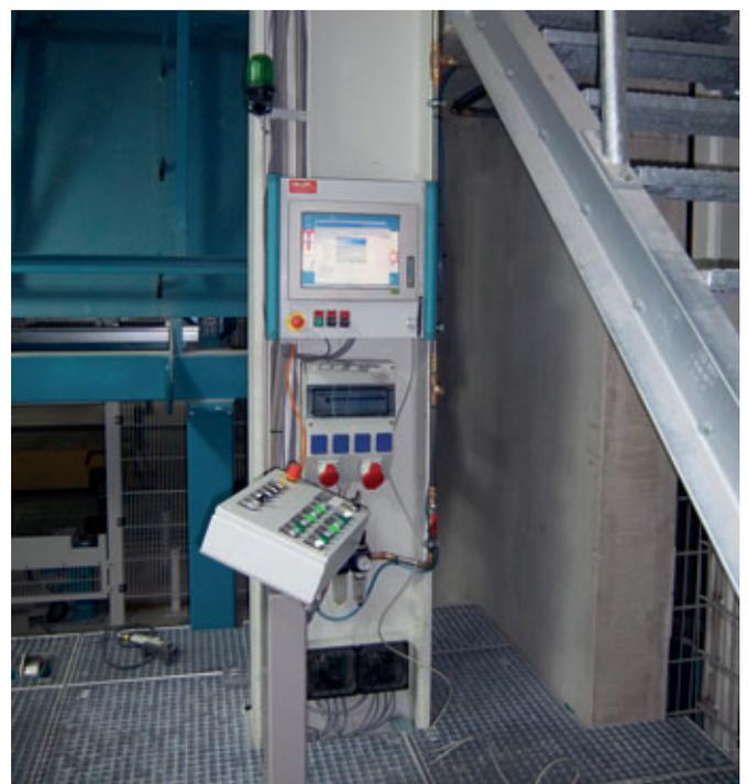
Los láser de cubierta permiten un control final exacto de los elementos que se van a hormigonar. Mediante el ordenador de mando para los láser se pueden visualizar los procesos de trabajo individuales que fueron necesarios para configurar la bandeja
