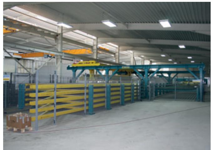
Para el procesamiento del acero, que está dispuesto sobre el procesamiento del hormigón, en primer lugar se endereza el acero de la bobina, luego se ajusta su longitud y después se procesa en la instalación de soldadura de mallas de funcionamiento completamente automático. El almacenamiento de mallas permite una producción continua y muy eficiente de las instalaciones de procesamiento de acero.
