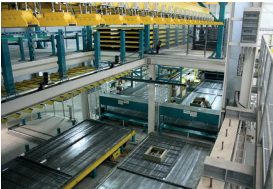
*El sistema de circulación está compuesto por zonas separadas en diferentes niveles para los trabajos críticos en cuanto al tiempo de ciclo, como por ejemplo el volteo de los muros dobles, el alisado o también la producción de muros dobles con aislamiento. Otras zonas, por ejemplo, para el encofrado, el armado y el hormigonado tienen vías dobles, para hacer posible un trabajo continuo sin cambio de bandejas*
