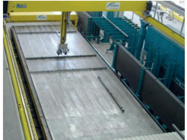
El robot multifuncional de encofrado (MFSR) ubica los encofrados sobre las bandejas con una exactitud de  $\pm 1$  mm. Los encofrados se pueden retirar posteriormente de las bandejas tan rápido como fueron colocados, también de forma automática
