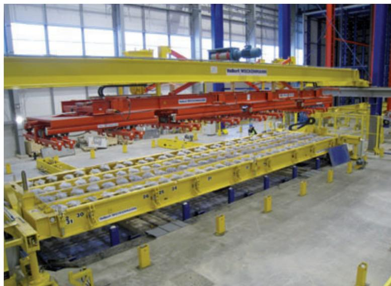
Рис. 12. Вакуумный подъемник и кантователь (во время сборки)
