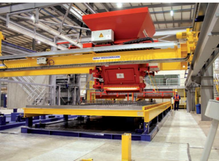
Рис. 9. Бетонораздатчик и станция уплотнения
