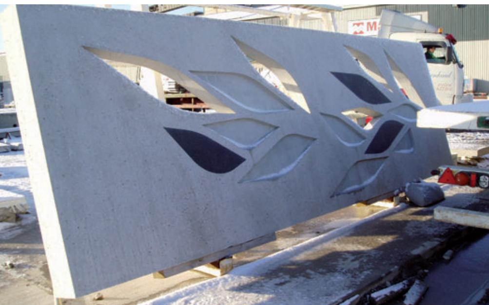
Рис. 2. Заказная сборная железобетонная панель на заводе Malling Products Ltd.
