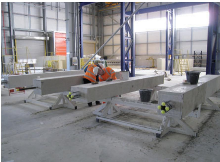
Рис. 22. Участок отделки и косметической обработки
