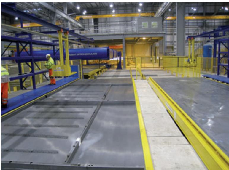
Рис. 8. Пост ручной укладки после опалубочного робота
