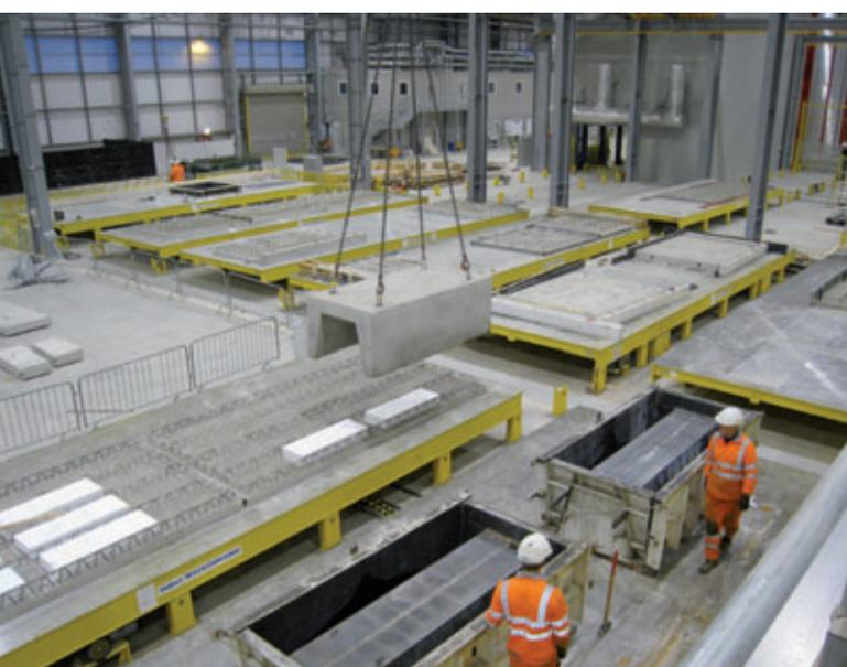
Рис. 17. Обзор специализированной циркуляционной системы «BSC»
