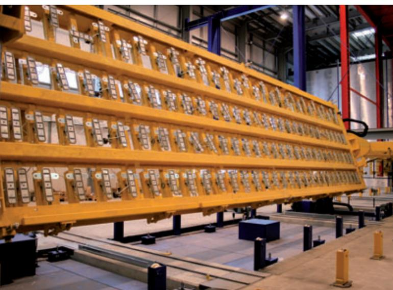
Рис. 11. Вакуумный кантователь
