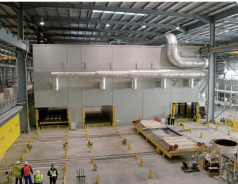
Рис. 20. Зона бетонирования и обработки поверхности, стеллажи для выдержки бетонных изделий
