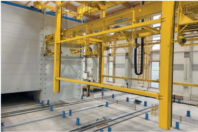
Am effektivsten erfolgt das Aushärten der Elemente in einer Trockenkammer. Das vollautomatische Ein- und Auslagern der Paletten übernimmt ein Regalbediengerät.
