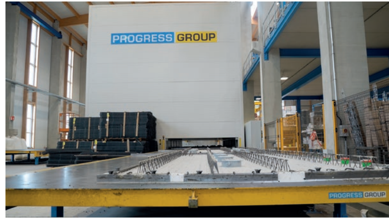
Am effektivsten erfolgt das Aushärten der Elemente in einer Trockenkammer. Das vollautomatische Ein- und Auslagern der Paletten übernimmt ein Regalbediengerät.
