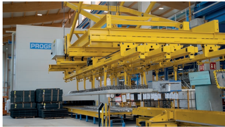
Mit der Abhebetraverse wird das fertige Element von der Palette entnommen und für den Weitertransport vorbereitet.
