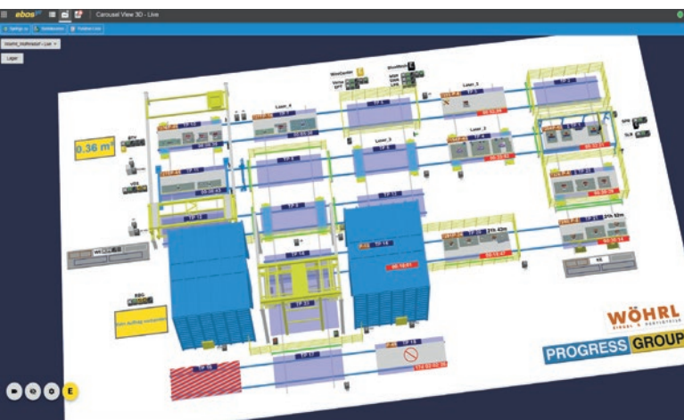
ebos yc steuert den Umlauf und ermöglicht durch 3D-Visualisierung die Echtzeitüberwachung und nachträgliche Analyse. Zudem stellen Smart Production Screens die jeweils benötigten Daten zum optimalen Zeitpunkt in der Produktion bereit.
