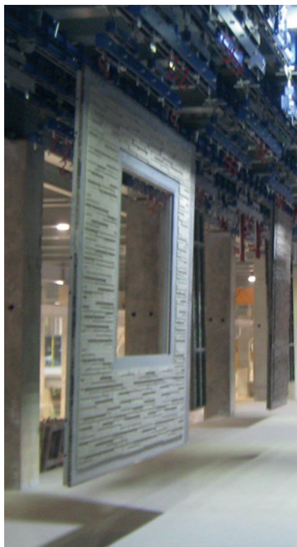
Матрица на транспортной тележке системы «Power and Free»
