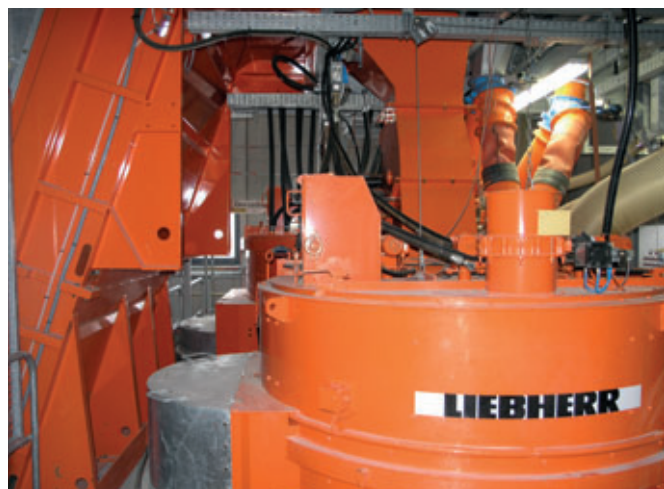
Два барабанных тарельчатых смесителя позволяют добиться высочайшего качества бетона за короткий цикл
