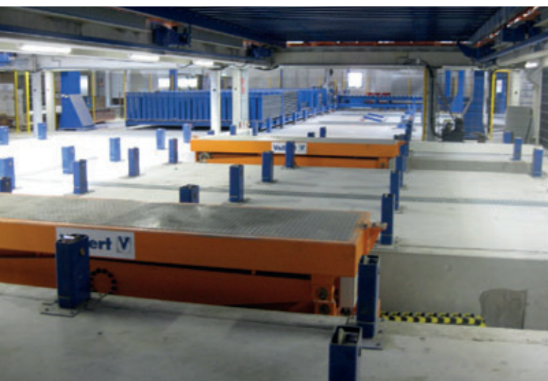
Гидравлические подъемные тележки Vollert поднимают поддоны с опалубкой на три позиции на станции ручной обработки на высоту 2,80 м
