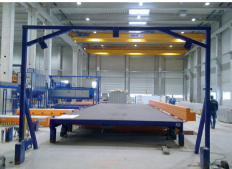
Перед съемом затвердевших элементов поддоны проезжают сквозь измерительные ворота, которые документируют и контролируют размеры элементов при помощи промышленных лазеров
