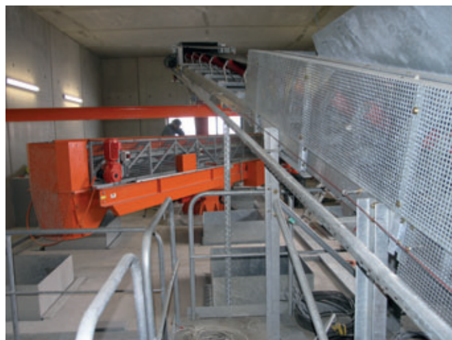
Роторные распределители под смесителями подают бетон в бетонораздатчик, автобетоносмеситель или воронку рециклинговой установки
