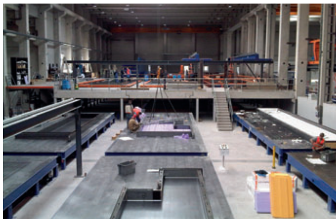
Для ручной укладки арматуры и изоляции поддоны подаются на три независимые, параллельно расположенные линии
