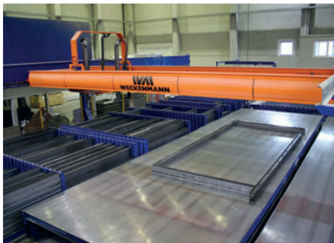
Опалубочный робот Twin Z отличается чрезвычайно коротким временем цикла укладки и позиционирования опалубки на стальные поддоны
