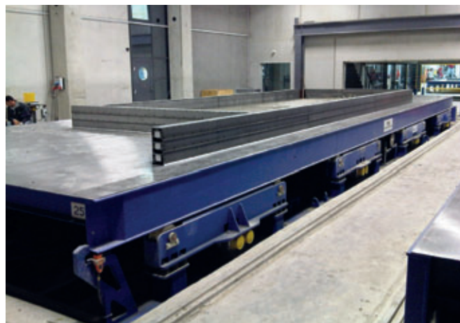
Уплотнение бетона происходит на комбинированной станции виброуплотнения со встряхиванием
