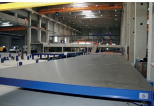
В общей сложности на заводе FBW эксплуатируется 40 опалубочных поддонов Weckenmann размером 14,00 x 4,60 м
