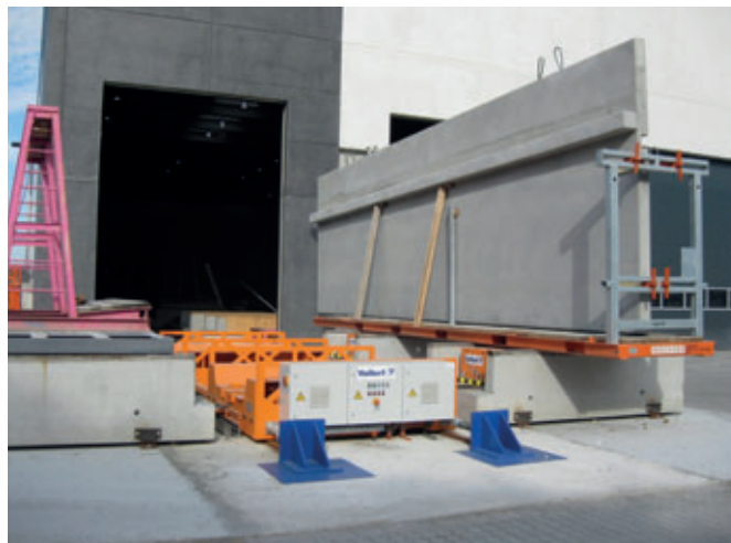
Решение компании Voller позволяет забирать стойки при помощи одной разгрузочной тележки с двумя поперечными подъемниками и затем транспортировать на склад под открытым небом
