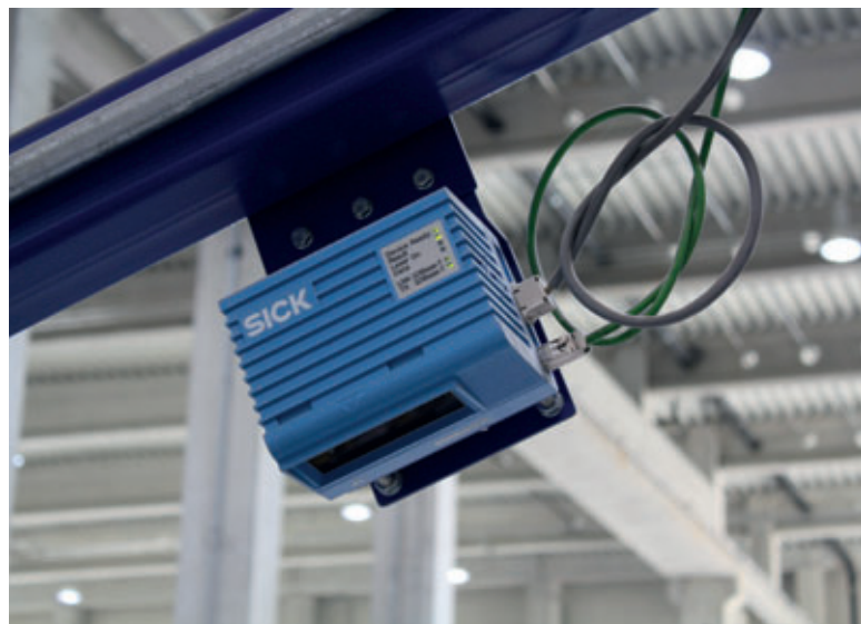
Перед съемом затвердевших элементов поддоны проезжают сквозь измерительные ворота, которые документируют и контролируют размеры элементов при помощи промышленных лазеров
