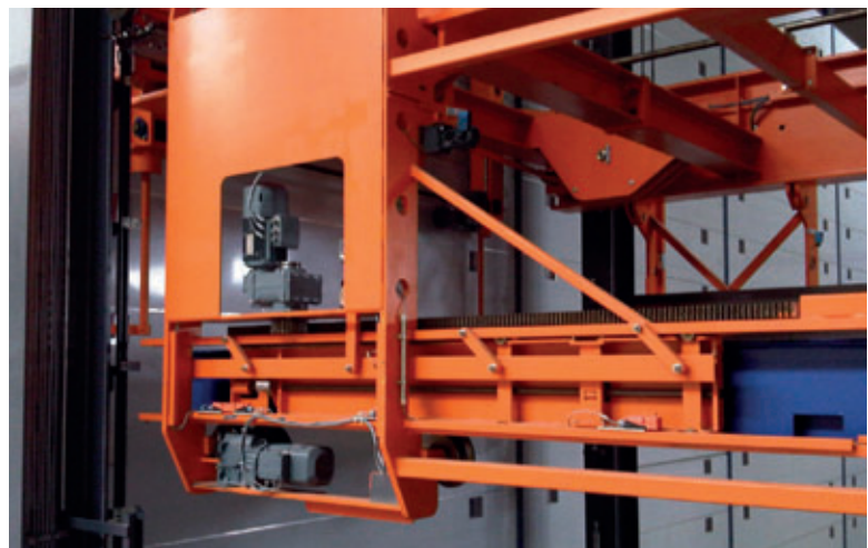
Ворота сначала в действие механизмом открытия сегментных дверей, после чего посредством фрикционных роликов и реечной задвижки поддоны помещаются в требуемый стеллажный отсек либо выгружаются из него
