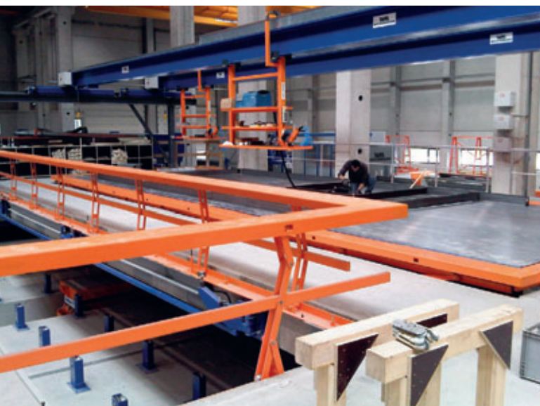
Во избежание сбоев ручные операции производятся на втором рабочем ярусе над системой циркуляции поддонов
