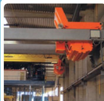
Drehkübel und Betonverteiler 3.000 l
