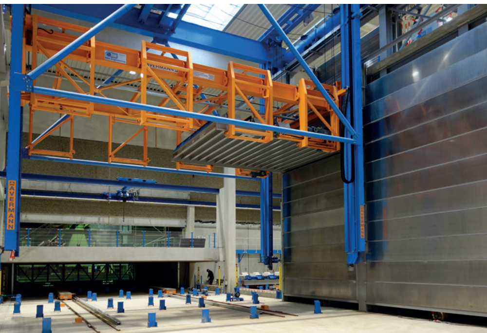
Стеллажный штабелер для обслуживания камер выдержки
