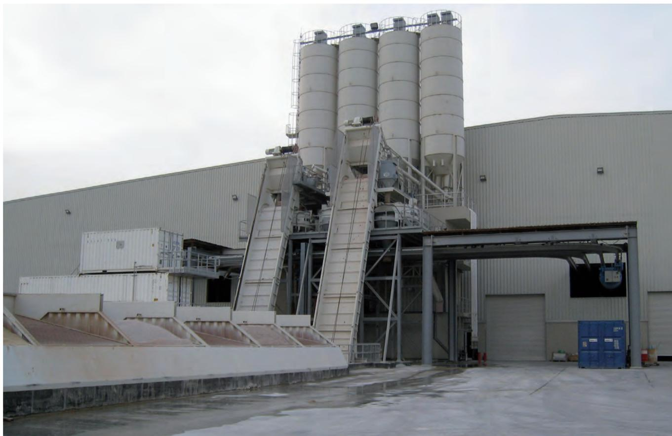
Бетономесительная установка и система раздачи бетона
