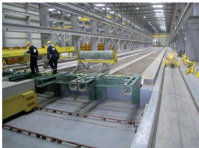
Линия производства пустотных плит
